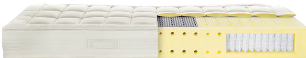
7-Zonen-Tonnentaschenfederkern. Schlanke Federn aus induktiv vergütetem Stahl, einzeln eingenäht in spezielle Vliestaschen.
